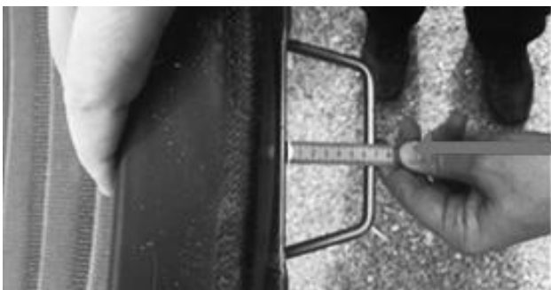
Stålbøyle/støtte bak sulkysetet får stikke ut maksimalt 60 mm.
